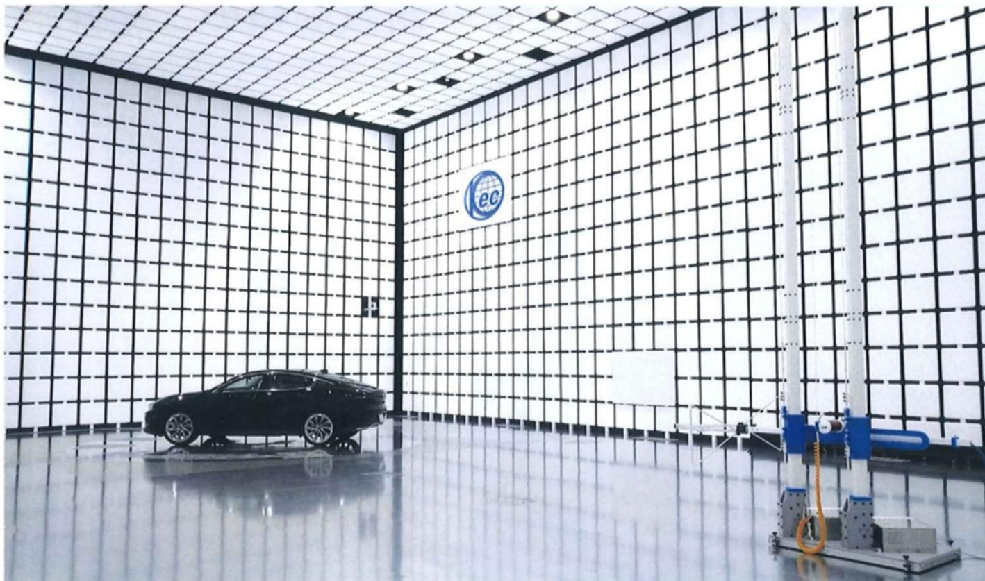
＊) KEC第16電波暗室：30MHz未満の電波伝搬特性(Normalized Site Insertion Loss)が規定された最新EMC国際規格(CISPR16-1-4:2023) に適合
